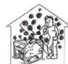
Les gaz d'échappement du moteur sont toxiques. Ne pas faire fonctionner le groupe électrogène dans des salles non ventilées. En cas d'installation dans des salles ventilées, des prescriptions supplémentaires en matière de protection contre l'incendie et l'explosion doivent être respectées. Il est impératif de placer le groupe électrogène
