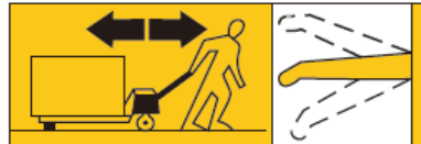
Levier point mort Déplacement de la charge
