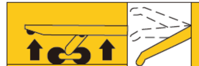
Levier position basse Montée du plateau
